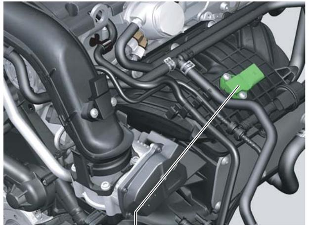
Saugrohrdruckgeber G71 mit Ansauglufttemperaturgeber G42 S405\_044
