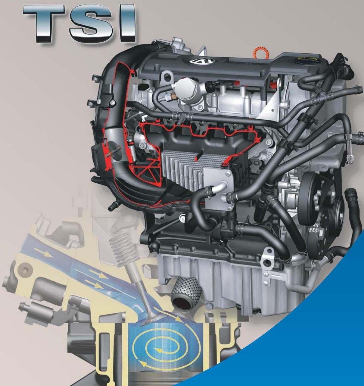
Der 1,4l-90kW-TSI-Motor ersetzt den 1,6l-85kW-FSI-Motor. Ihm gegenüber erzielt er bei deutlich reduziertem Kraftstoffverbrauch und CO<sub>2</sub>-Ausstoß wesentlich verbesserte Fahrleistungen.
