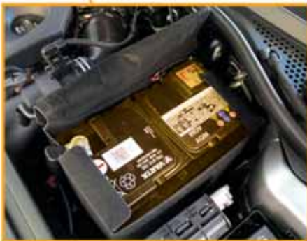
12V-Batterie im Motorraum
