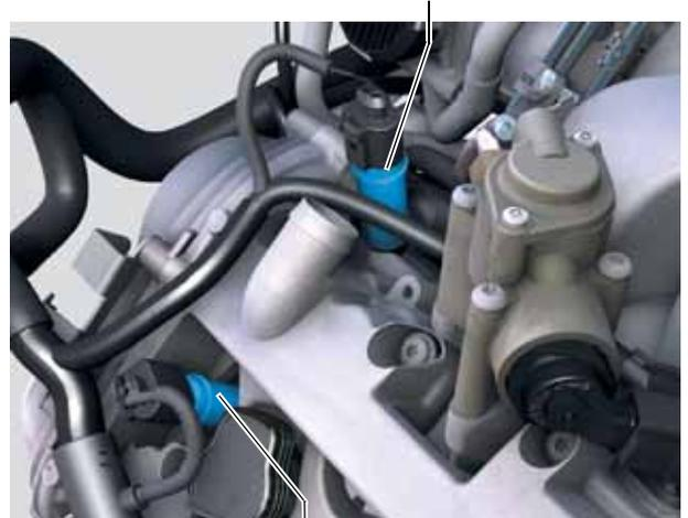
Ventil 1 für Nockenwellenverstellung im Auslass N318
