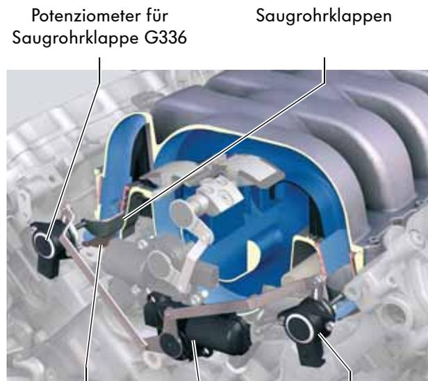
Potenziometer für Saugrohrklappe G336
