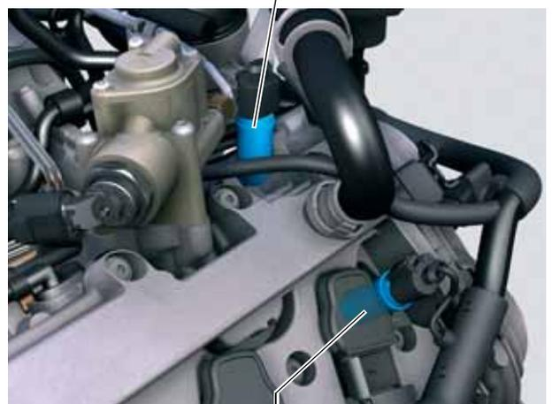
Ventil 2 für Nockenwellenverstellung im Auslass N319
