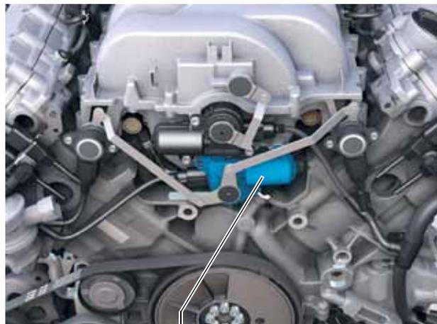
Motor für Saugrohrklappe V157
