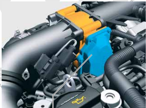
Regelklappen-Steuereinheit J808 mit Stellmotor für Regelklappenverstellung V380 S359_107
