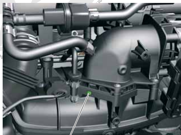
Sichtfenster für Dichtung zwischen Saugrohr und Saugrohrstützen
